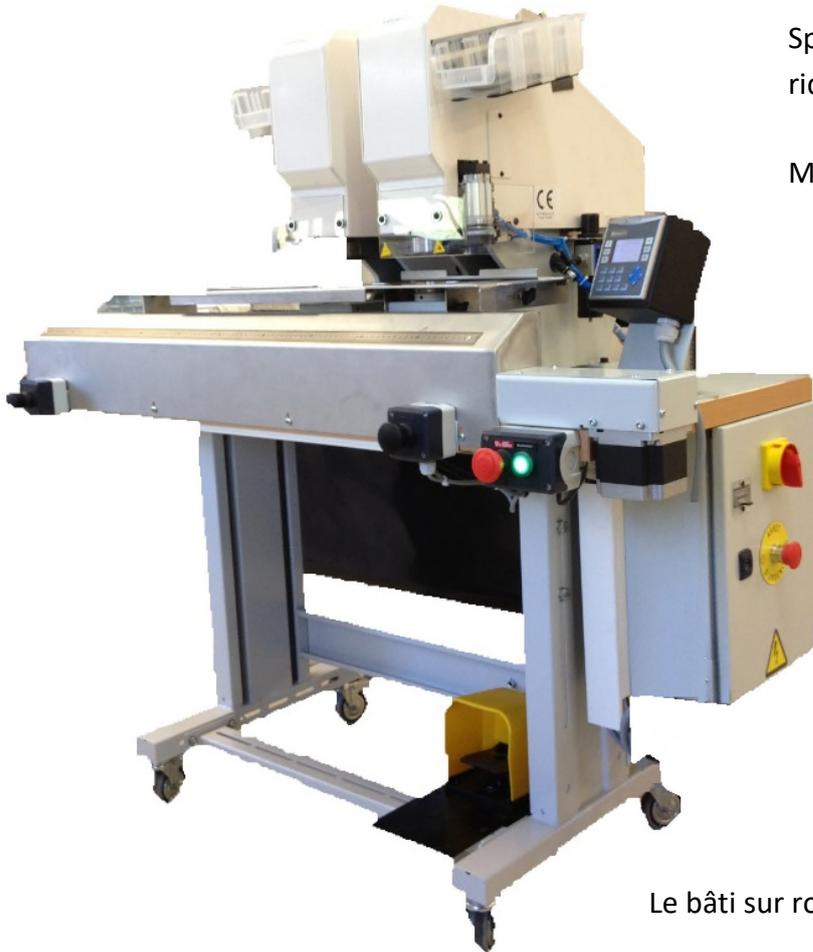
Spécifiquement développée pour la pose d'œillets de rideaux ( $\varnothing 8$  à  $\varnothing 40$ mm).
